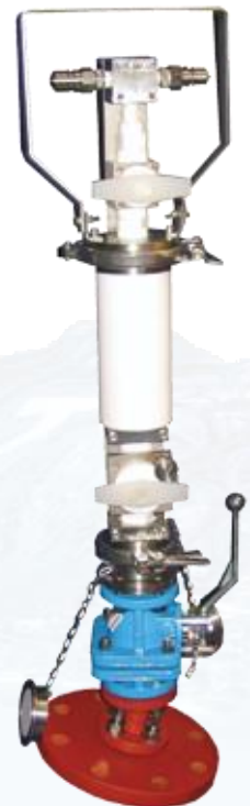
Sistema di campionamento di recipienti senza rivestimento su scala di laboratorio con valvole di tipo Swagelok.
