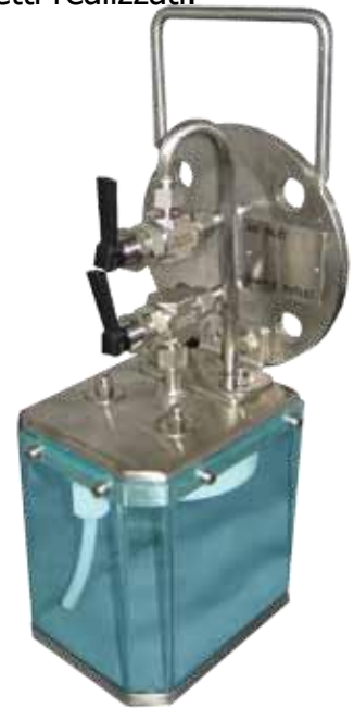
Sistema di campionamento di recipienti senza rivestimento su scala di laboratorio con valvole di tipo Swagelok.
