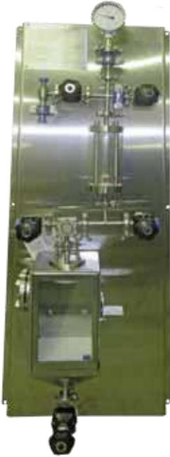
Sistema di campionamento a vaso indipendente per il campionamento di liquori di processo instabili con autodrenante, design a fessura zero ed espulsore per generare il vuoto.
