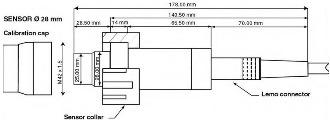
Questo sensore di ozono si basa su una cella di Clark ed è costituito da una membrana semipermeabile, elettrodi oro e argento immersi in una soluzione elettrolitica. La membrana ospita l'elettrolito e agisce da barriera al campione consentendo il passaggio solo di piccoli gas molecolari per contattare il catodo dorato e reagire.
