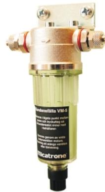
VM-5 è usato quando c'è rischio di condensazione, e' connesso al tubo di pressione. Questo può necessitare quando il tubo percorre zone a differenti temperature. VM-5 è montato nella parte più bassa del tubo di pressione tra le uscite di misura ed il trasmettitore o controllore.
