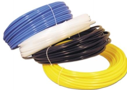
Tubo di pressione in polietilene (PE) e poliammide (PA) per una sicura ed adatta connessione a trasmettitori PE-tubo bianco o giallo per una temperatura max di 60°C e PA-tubo in colore blu o nero per max temp. di 100°C. Il HT-tubo può essere ordinato rotoli di 50m (8/6) o rotoli da 100m (6/4) ed anche per metro.
