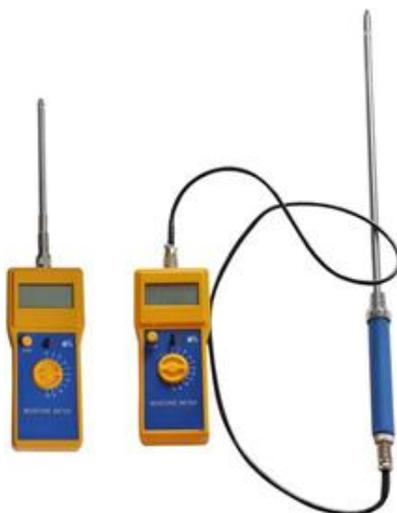
Igrometro per nocciole sonda applicato per misurare il contenuto di umidità anche di chicchi di caffè, fave di cacao, noci, anacardi, pistacchi.
