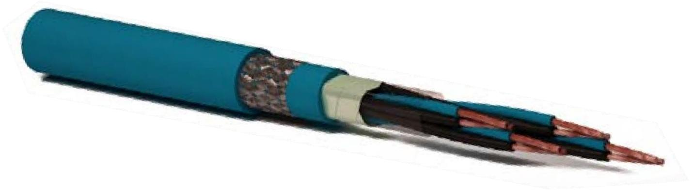
Cavo multiconduttore ATEX, multiparto o multitriplo, armato con treccia di filo d'acciaio zincato, schermato sul set con alluminio / poliestere per la protezione da disturbi elettrici ed elettromagnetici, destinato alla trasmissione di segnali di controllo, strumentazione, allarme, sicurezza, ecc. nei processi industriali dove è richiesta anche una maggiore flessibilità e cavi senza fiamma alogeni non propaganti l'incendio.
