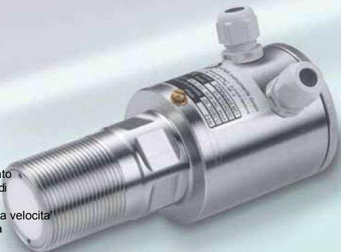
*Il sistema di misura del **DYNAguard M** è basato sul principio fisico dell'effetto Doppler. Il sensore invia un campo di microonde che è riflesso dai solidi che si muovono attraverso l'area di rilevazione. Il sensore triboelettrico valuta le microonde e le converte in un segnale tramutato poi in uno switch di uscita. Il materiale fermo non è rilevato (come depositi etc).*
